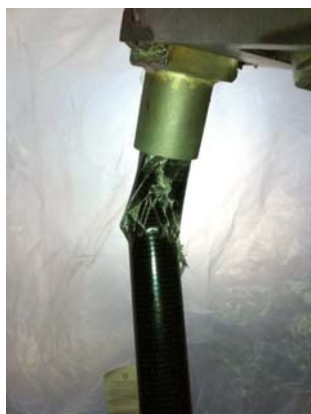
Rupture des tubes lors d'essais de flexion et de compression
