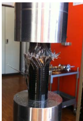
Rupture des tubes lors d'essais de flexion et de compression
