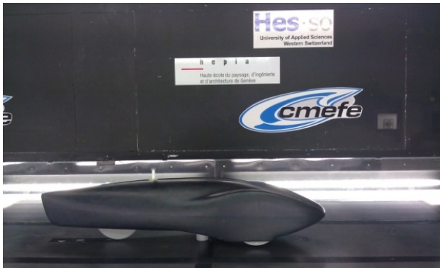
Maquette de la BioMobile dans la soufflerie. On voit la sonde Irdam montée sur l'extrados
