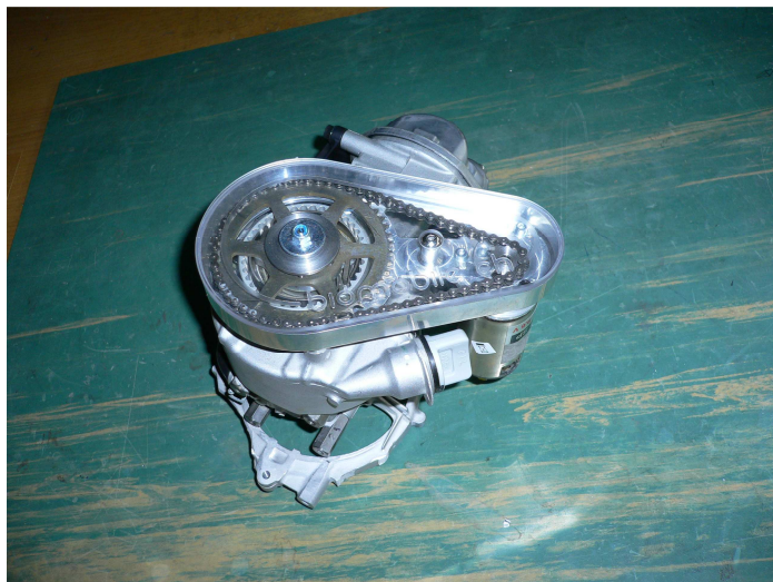
La nouvelle roue-libre du démarreur et son entraînement
