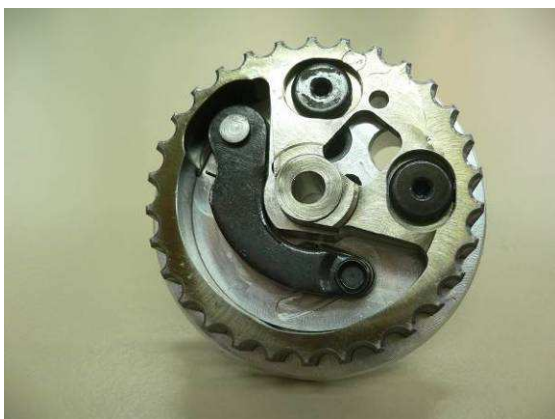
Le support des cames, avec le décompresseur (en noir) ou, une alliance élégante entre l'aluminium, l'acier et le titane
