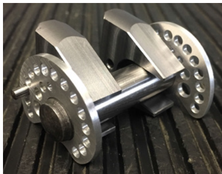
Le dispositif de réglage de la tension de chaîne basé sur un excentrique
