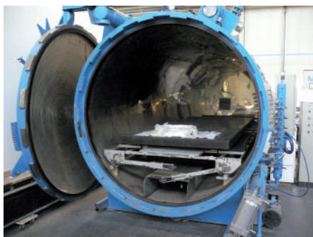
L'autoclave mis à notre disposition Le moule de la jante (en blanc) semble bien petit...
