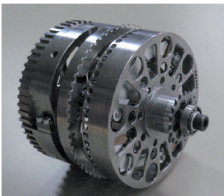
L'ensemble embrayage-volant conçu par des étudiants de l'EPFL et réalisé par l'atelier de mécanique de cette école
