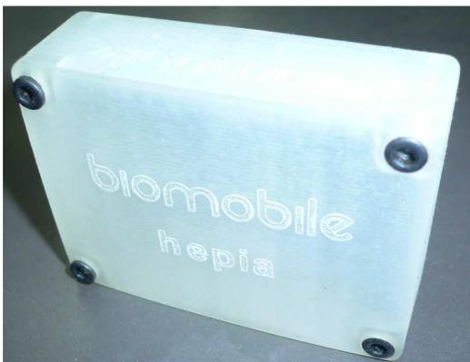
*Un boîtier électronique destiné à BioMobile réalisé par stéréolithographie sur les installations de M. Richard.*
