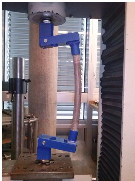
Des difficultés ont été rencontrées lors de l'utilisation de tubes en tant qu'éprouvette de caractérisation. Pour les contourner, nous avons finalement utilisé des éprouvettes plates. De nombreux facteurs ont été mis en évidence tels que : la pré-cuisson des fibres, la post-cuisson du composite, la pression utilisée lors de la polymérisation, etc. Basés sur un plan d'expérience, plus de 81 essais mécaniques ont été réalisés.
