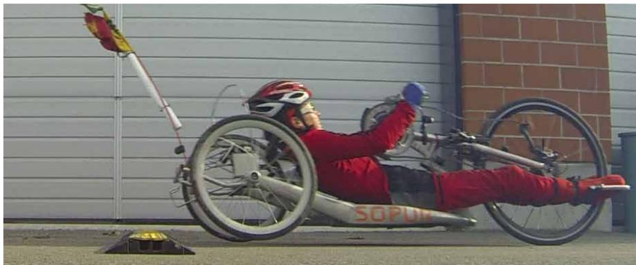
Passage d'un obstacle lors des mesures de forces. On voit très nettement la déformation du châssis.
