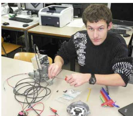
Simon ajuste le banc d'essais de levée de soupape.
