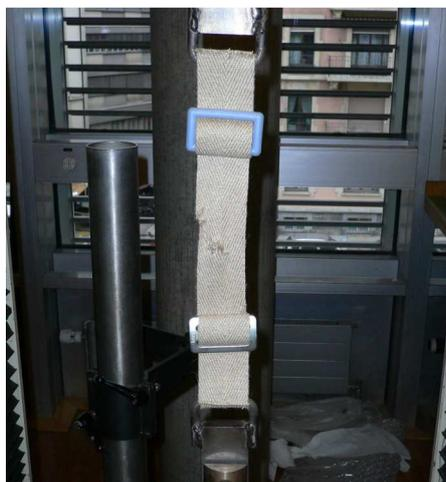
*Les sangles sur la machine de traction du laboratoire des matériaux d'hepia après la rupture... sous une charge de 4950 N, soit pratiquement 500 Kg !*
