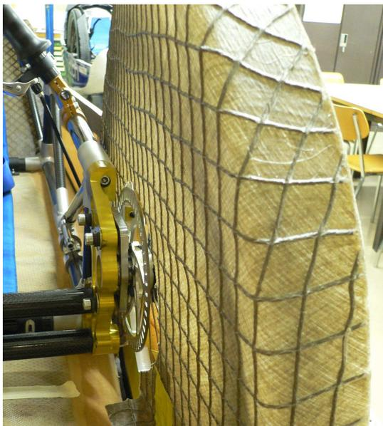
Les passages de roues sont les premiers éléments fabriqués selon le procédé PowerRibs développé et breveté par notre partenaire Bcomp.
