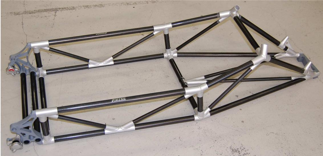
*Le nouveau châssis étudié et réalisé par Futech en fibres de carbone et aluminium.
