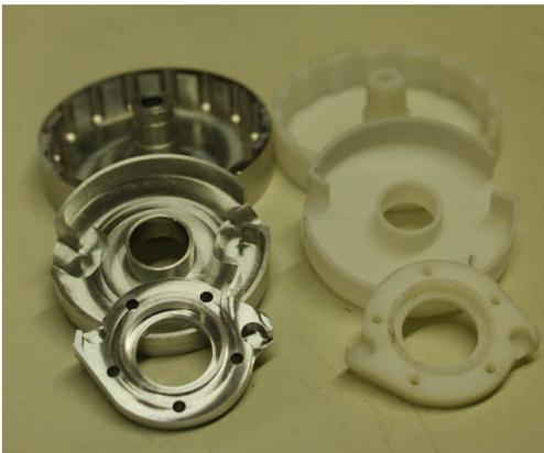
*Une partie des pièces conçues et usinées par le lycée Savoisiennne. Les pièces de droite sont réalisées selon le principe de la stéréolithographie. Elles servent à vérifier les principes.*
