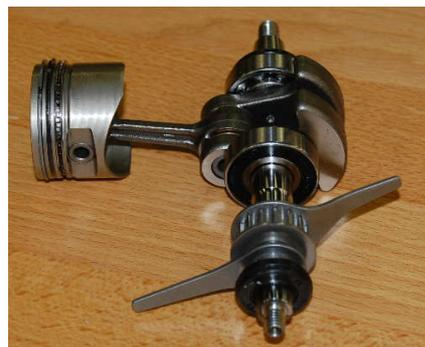
*Vue de l'équipage mobile avec les "pales de moulin" qui assure la lubrification dans le modèle d'origine*
