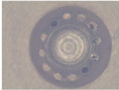
Tête de l'injecteur. Dix perçages ont été obturés par des micro-goupilles pour adapter le débit au GX25. Chaque orifice a un diamètre de 0.1 mm !!!
