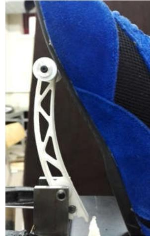
*Test la résistance mécanique de la pédale de frein sous charge (la partie bleue est le pied de Léonard !
