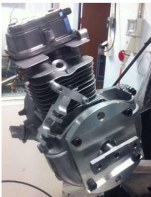
Par la suite, il a conçu l'alimentation en biométhane et le support de l'injecteur, adapté les différents éléments de l'embrayage et de la transmission et a dessiné un nouveau volant d'inertie ayant les mêmes caractéristiques que le volant d'origine.
