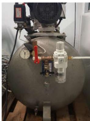
La mise en service du banc moteur a aussi pris beaucoup de retard; principalement du fait que la gestion du refroidissement du frein pose problème. Pour fournir l'air comprimé nécessaire à son refroidissement, nous devons recourir à un compresseur d'assez grande taille. L'alimentation en air comprimé sera assurée par un compresseur, déjà ancien mais que nous avons remis en état pour cette tâche.
